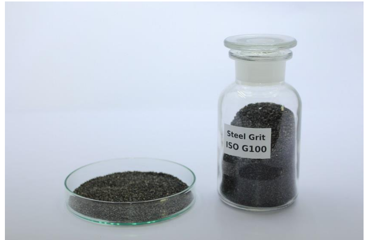
گریت فولاد ریختگی کربن بالا ISIRI G100 معادل SAE G25
