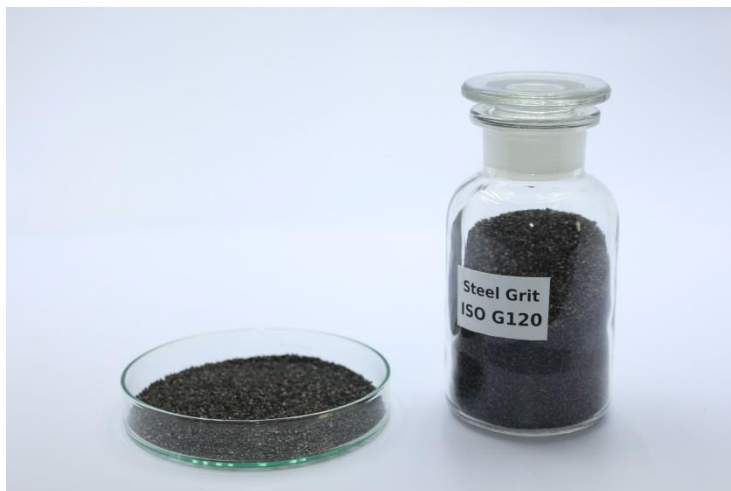
گریت فولاد ریختگی کربن بالا ISO G120 معادل SAE G18
