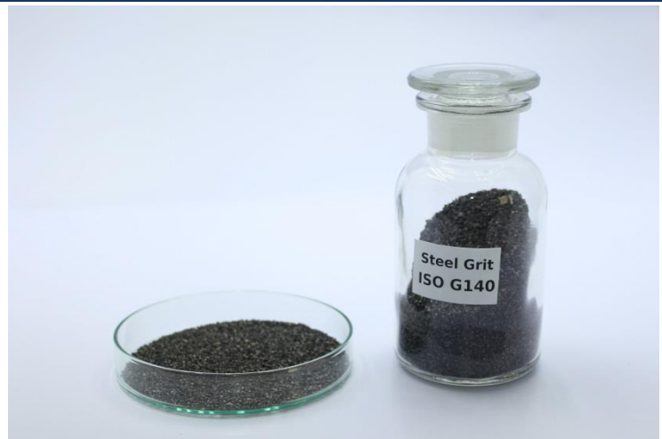
گریت فولاد ریختگی کربن بالا ISIRI G140 معادل SAE G16
