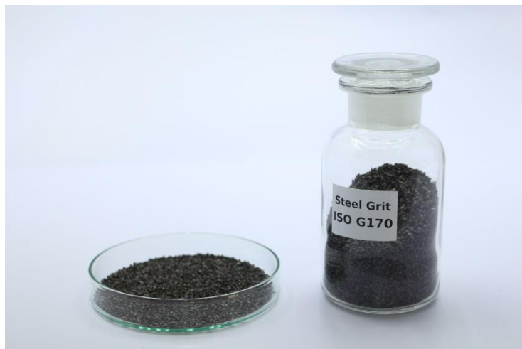
گریت فولاد ریختگی کربن بالا ISIRI G170 معادل SAE G14
